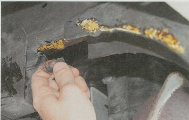
Neuralgische Punkte: An Ecken und Kanten sowie hinter angeschraubten Teilen versteckt sich mehr Rost als erwartet – der Profi rät zum Eisstrahlen
